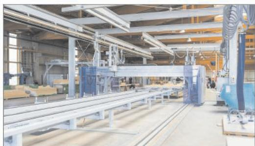
Um flexibler und leistungsfähiger zu sein, hat sich Haas Fertigbau eine neue Abbundanlage des Typs Hundegger K2-Industry angeschafft. Foto: zVg
